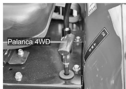
Enganche y desenganche la tracción delantera con las ruedas delanteras rectas y a bajas revoluciones. El uso de tracción delantera aumenta la potencia de tracción
