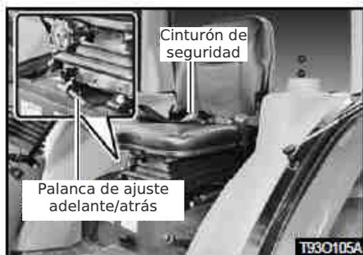
Antes de empezar a trabajar con un tractor, es importante ajustar el asiento para la posición más confortable y verificar si está debidamente fijo en esa posición.
