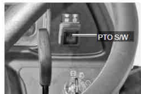
**El eje de la TDF no gira si cualquiera de los dos interruptores está en la posición de OFF.**
