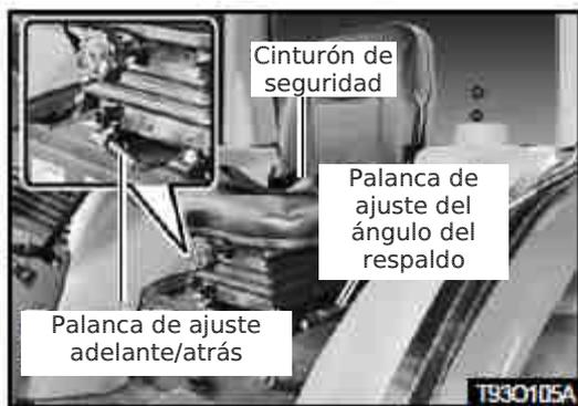
Para ajustar el ángulo del respaldo, levante la palanca al lado izquierdo del asiento. A continuación, deslice el asiento para la posición deseada. Suelte la palanca. Se certifique que el asiento está fijo en esa posición.
