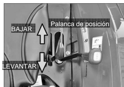
**Para levantar el apero:** Tire de la palanca para atrás.
