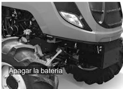
La función del interruptor de desconexión de la batería es desconectar el suministro eléctrico a todo el sistema eléctrico interrumpiendo la conexión a la batería. Esto beneficia, en particular, la seguridad y el funcionamiento del tractor:
