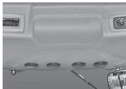
Para calentar la cabina rápidamente, la perilla debe girarse completamente en el sentido de las agujas del reloj y el ventilador debe ajustarse a la velocidad 4. El parabrisas se descongela o descongela con el aire dirigido a través de los orificios del ventilador. Para descongelar o desempañar rápidamente, todos los demás ventiladores deben estar cerrados.
